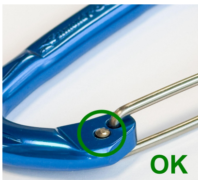
Klinkverbinding OK, afgerond uiteinde in de vorm van een "paddenstoel"
