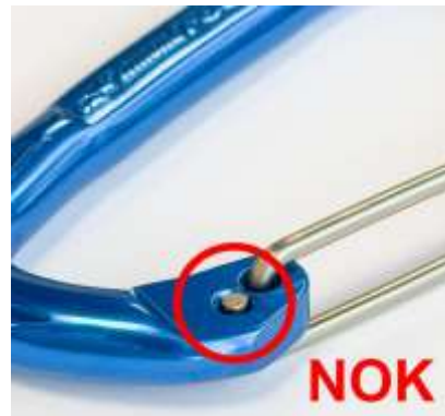
Дефектен нит, с плоска форма
