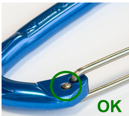
Nituire OK, capăt rotunjit în formă de „ciupercă”
