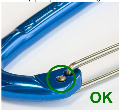
Nitowanie prawidłowe, zaokrąglony koniec w kształcie „grzybka”
