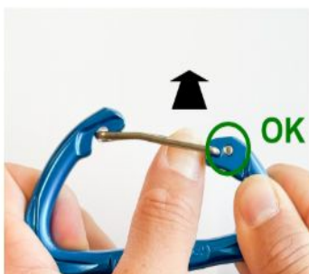
Nietung ok, von außen sichtbares Teil ist abgerundet
