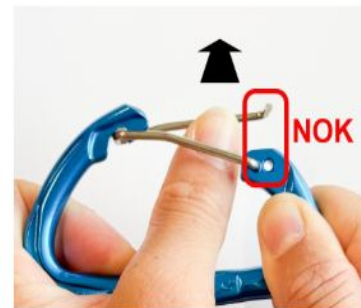
Nietung nicht ok, von außen sichtbares Teil ist flach
