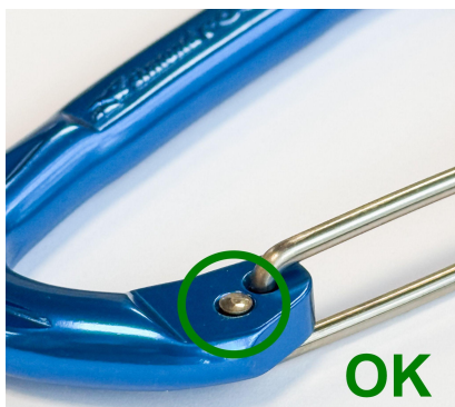
Rivetage OK, extrémité arrondie en forme de "champignon"
