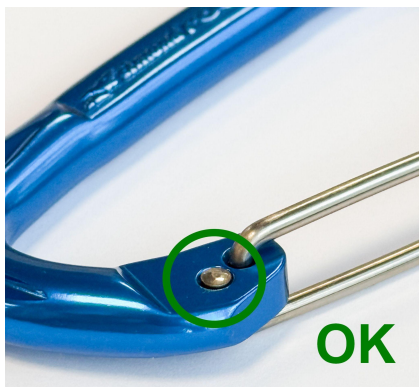
Remachado OK, extremo redondeado en forma de "hongo"
