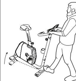
Mettersi di fronte al prodotto, porre un piede sulla gamba anteriore della cyclette, poi tirare a sé il manubrio per inclinare la cyclette in avanti, per mettere le rotelle di spostamento a contatto con il pavimento. Durante questo movimento, è importante mantenere la schiena dritta. Nello spostare la cyclette, occorre esercitare una forza essenzialmente con le braccia e le gambe.
