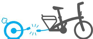
En caso de pinchazo de la rueda trasera, conviene desconectar el cable motor antes de retirar la rueda para su reparación.
