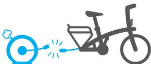
În caz de pană la roata din spate, deconectați cablul motorului înainte de a scoate roata bicicletei pentru a efectua reparația.
