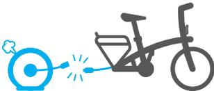
En cas de crevaison de la roue arrière, pensez à déconnecter le câble moteur avant de retirer la roue du vélo pour effectuer la réparation.
