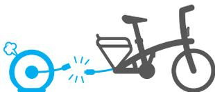
U slučaju da pukne guma na zadnjem točku, setite se da izvučete kabl motora pre skidanja točka radi popravke.
