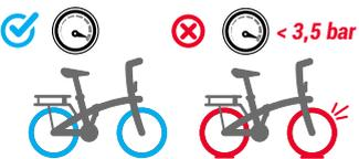
3. La autonomía y el rendimiento serán mejores con los neumáticos inflados a una presión de entre 4,5 bares. Alto riesgo de pinchazo si la rueda no está suficientemente hinchada
