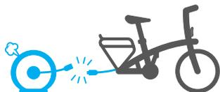
V prípade prepichnutia zadného kolesa nezabudnite odpojiť kábel motora, skôr ako koleso odmontujete z bicykla za účelom vykonania opravy.
