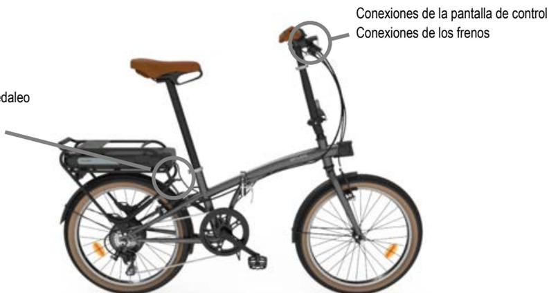
Conexiones de la pantalla de control
