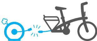
Σε περίπτωση διάτρησης του πίσω ελαστικού, αποσυνδέστε το καλώδιο του κινητήρα πριν αφαιρέσετε τον τροχό του ποδηλάτου για επισκευή.
