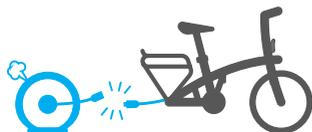
In caso di foratura della ruota posteriore, disconnettere il cavo motore prima di togliere la ruota della bicicletta per effettuare la riparazione.
