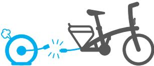
W razie przebicia opony w tylnym kole przed zdjęciem koła w celu przeprowadzenia prac naprawczych należy odłączyć kabel silnika.
