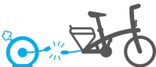
Vid punktering på bakhjulet, kom ihåg att koppla loss motorkabeln innan du avlägsnar hjulet från cykeln för att utföra reparationen.
