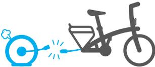
Falls der hintere Reifen beschädigt ist, denken Sie daran, das Motorkabel auszustecken, bevor Sie die Reparatur vornehmen.
