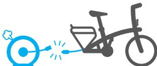
В случае прокола заднего колеса не забудьте перед снятием колеса для выполнения ремонта отсоединить кабель двигателя.
