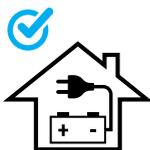
Ricaricare completamente la batteria almeno ogni 3 mesi.
