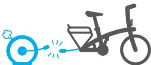
Als u een lekke achterband hebt, denk er dan aan de motorkabel te verwijderen voordat u het wiel ter reparatie van de fiets haalt.
