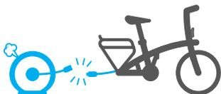
Em caso de punção da roda traseira, lembre-se de desconectar o cabo do motor antes de retirar a roda da bicicleta para executar a reparação.
